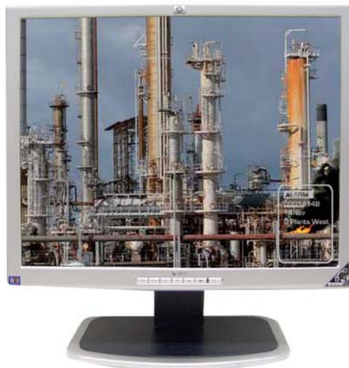
Alarme FLAMEVision superposée sur l'image de la caméra de vidéosurveillance (illustration uniquement)
