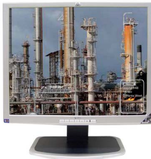
Alarma FLAMEVision superpuesta a la imagen CCTV (sólo a título de ejemplo)
