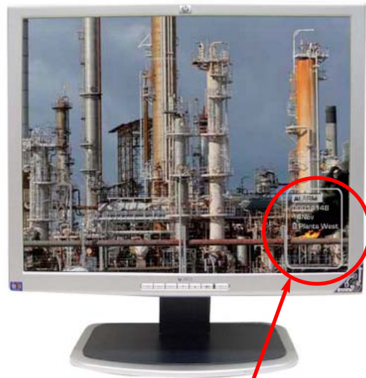
FLAMEVision-Alarm wird über das Videoüberwachungsbild überlagert (nur zur Illustration)
