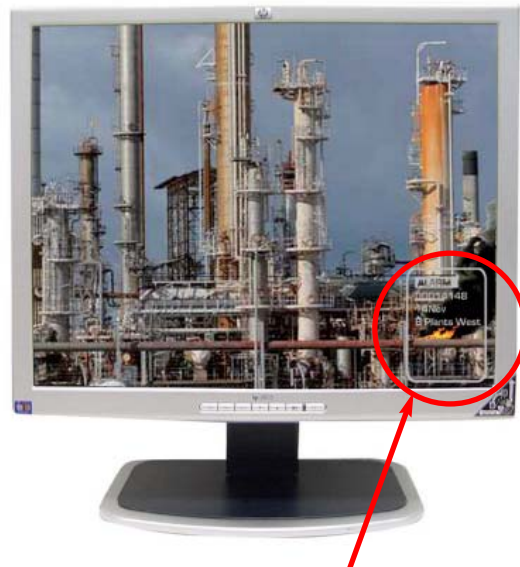
FLAMEVision-Alarm wird über das Videoüberwachungsbild überlagert (nur zur Illustration)
